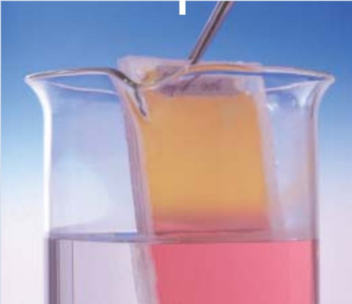
Kunststoffe wechseln die Farbe, wenn sich die Temperatur ändert. © Fraunhofer IAP
